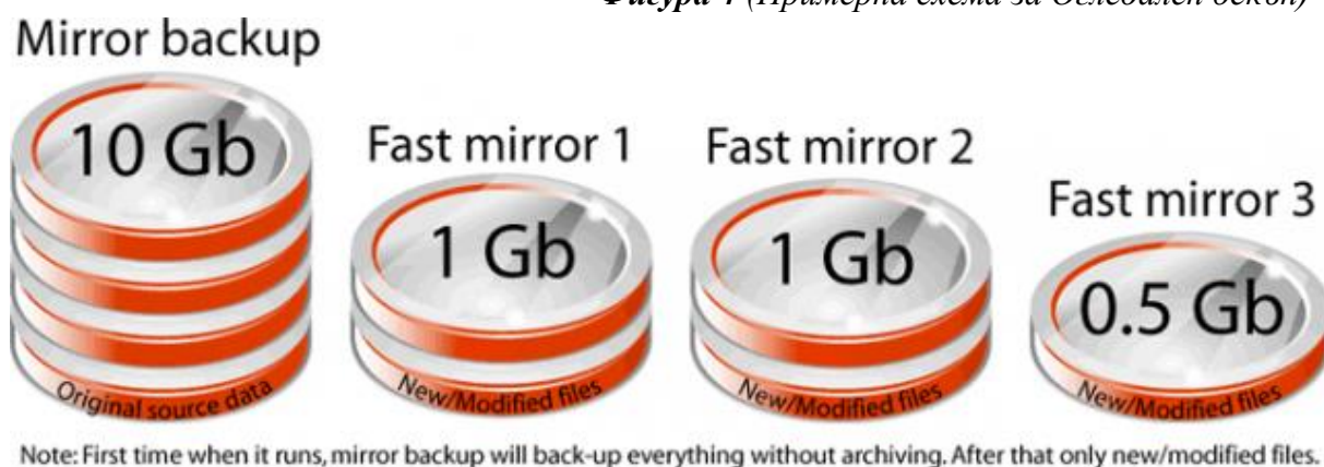
Фигура 4 (Примерна схема за Огледален бекъп)
