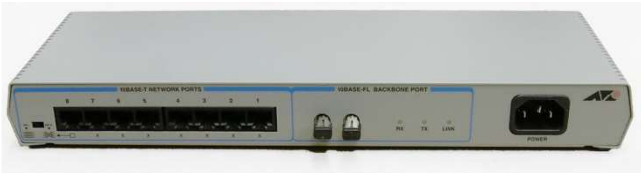
Фиг.19 – Концентратор (HUB)(4)
